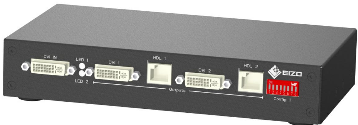
Der DVI-Splitter TID0102 teilt das DVI-Signal des LMM0804 in zwei konfigurierbare Signale. Der TID0102-HDL ist zusätzlich mit der HDL Streckentechnologie ausgestattet, um Videoübertragung auf herkömmlichen CAT-Kabeln bis zu einer Übertragungslänge von 70 m zu ermöglichen.
