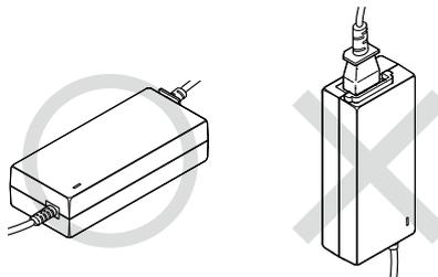
Korrekt: Horizontal platziert    Nicht korrekt: Vertikal platziert
