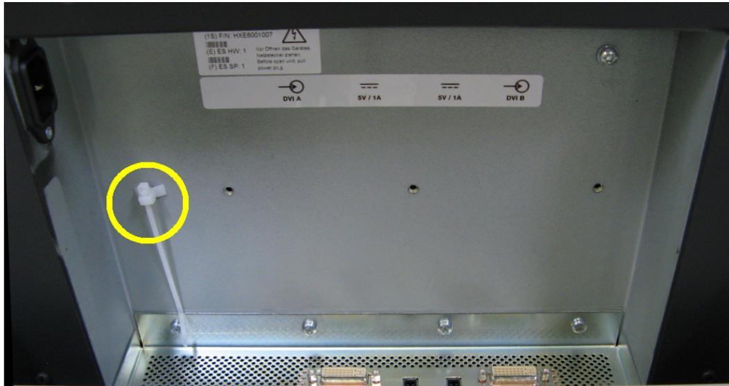
5. Stecken Sie die DVI-Kabel direkt in die DVI-Buchsen. Es dürfen nur Dual Link-DVI Kabel mit entsprechend hoher Qualität verwendet werden.
