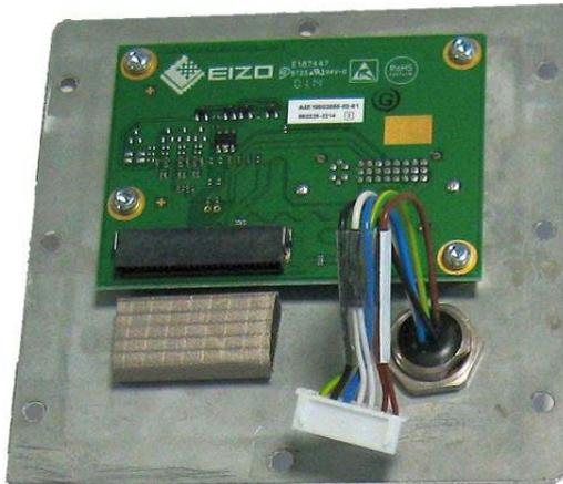
Abb.: Ausgebautes Eingangsmodul
