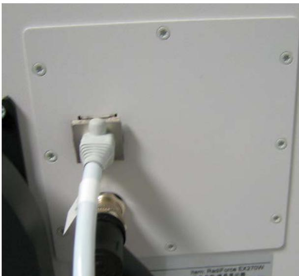
Abb.: Montiertes EMV-Kissen und Halteblech am Eingangsmodul TRM0000-TDL
