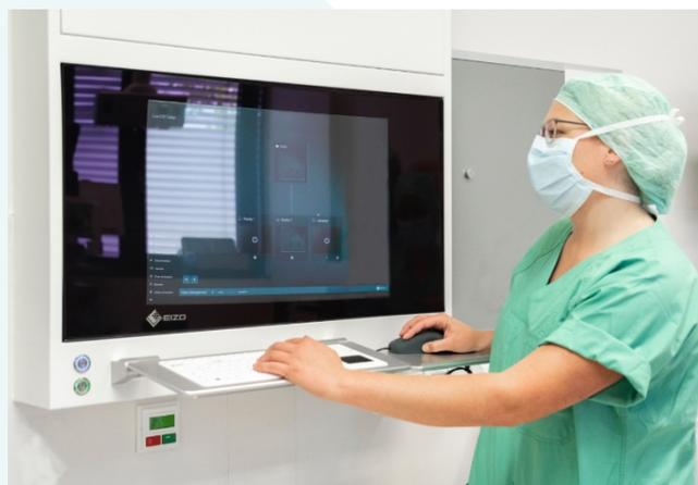
Die Bedienung des Systems erfolgt am wandmontierten Arbeitsplatz über das 24" Touch Display des **Surgical Panel SP1-24T**.
